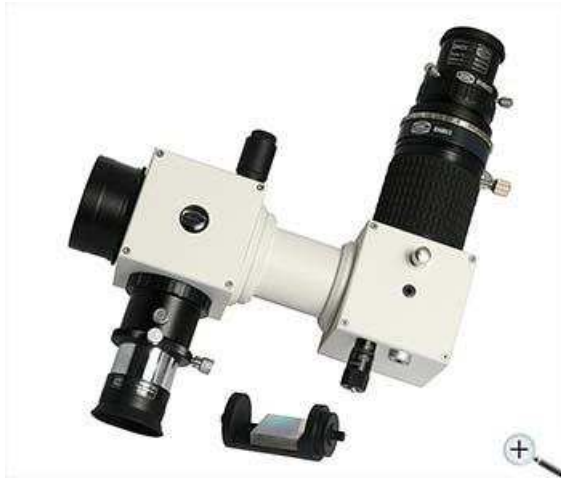
Abbildung 14 Zeigt den Dados-Spektrographen
