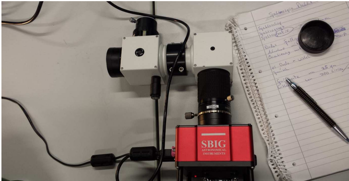
Abbildung 15 DADOS Spektrograf + SBIG STF-8300M CCD-Kamera
